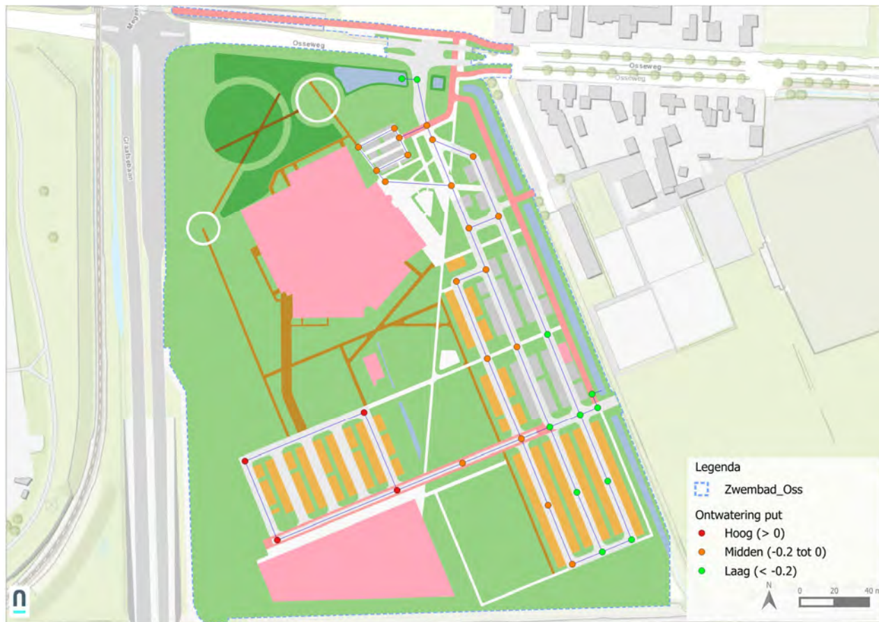
Figuur 12 Water op straat bui 10
