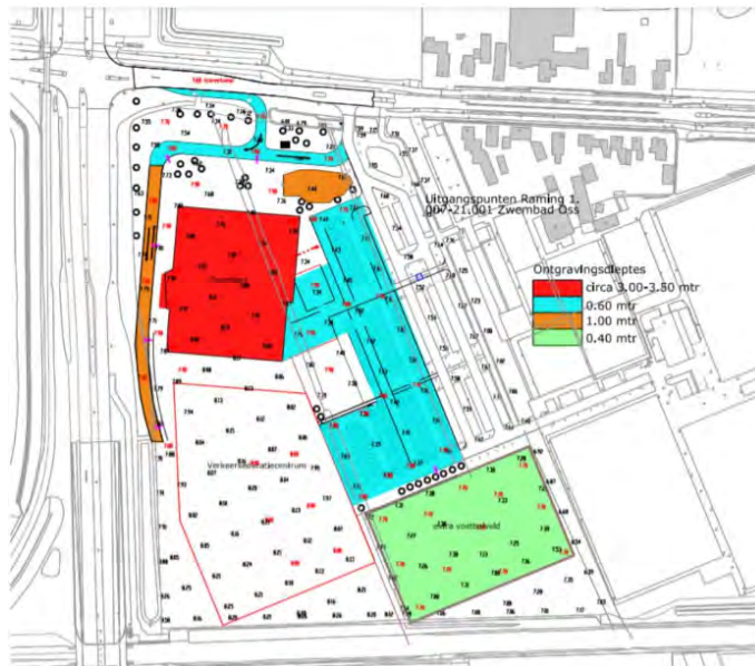
Figuur 3.1 plaatselijke ontgravingsdieptes
