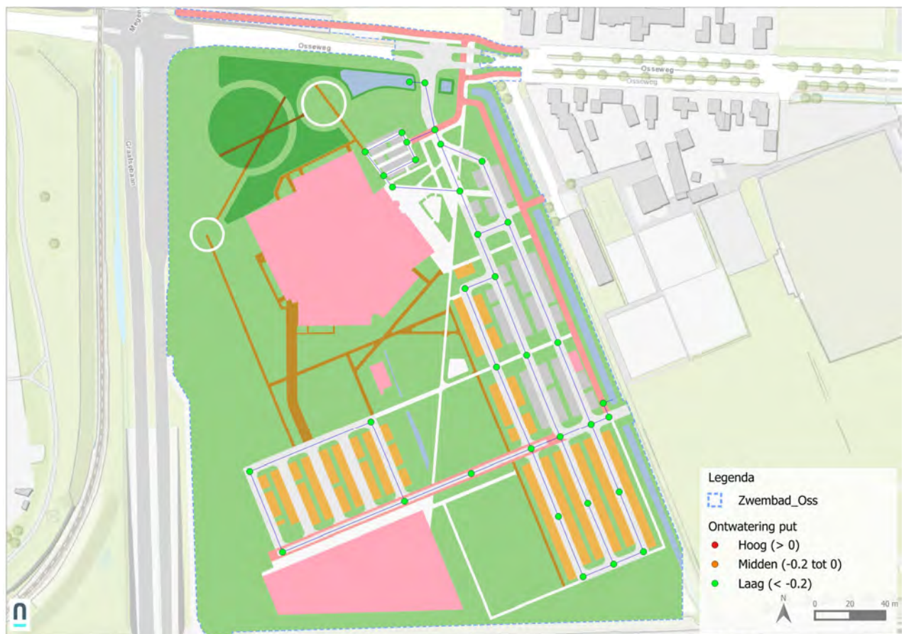
Figuur 11 Water op straat bui 9
